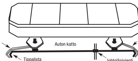
2. Säädä kiinnikkeiden leveyttä löysentämällä neljä ruuvia ja siirtämällä kiinnikettä siten, että metallikiinnekke ulottuu tippalistoihin.
