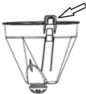
3. Sæt et filter af størrelse 1 x 4 i filterholderen.
