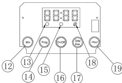
2. Ställ klockan så att den visar nuvarande klockslag (ex. 18.30) genom att använda "Min"- och "Hour"-knapparna (12 och 19).
