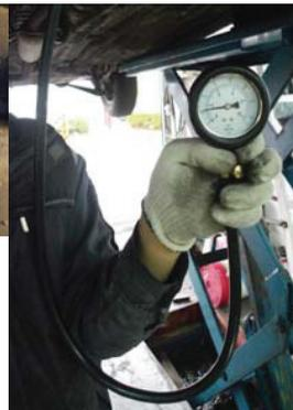
Fjern skruen og oljetrykksensoren, velg egnet testadapter og koble til manometeret. Start bilen, og les av manometeret.
