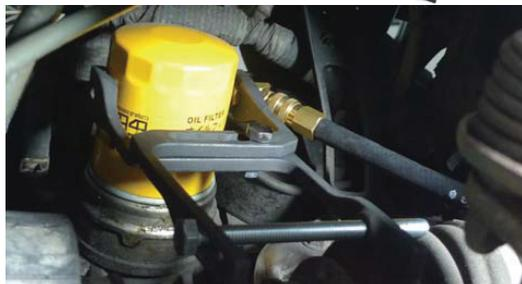
Applicera bygeln på oljefiltret enligt bilden och spänn skruven så att nålen (19 mm) går in i oljefiltret. Anslut manometern.
