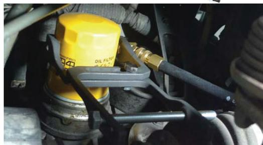
Asenna sanko öljysuodattimeen kuvan osoittamalla tavalla ja kiristä ruuvia niin, että neula (19 mm) tunkeutuu öljysuodattimeen. Liitä painemittari.
