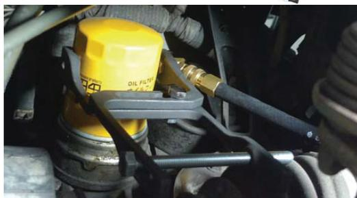
Monter bøjlen på oliefiltret iht. illustrationen, og spænd skruen, så nålen (19 mm) går ind i oliefiltret. Tilslut manometeret.
