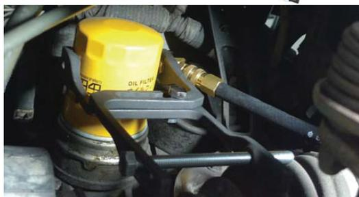
Fest bøylene på oljefilteret som vist på bildet, og stram skruen slik at nålen (19 mm) går inn i oljefilteret. Koble til manometeret.
