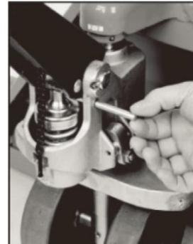
8. Mat kjedet, og monter mutrene på kjedets gjen- gestav. TIPS! Senk pumpehåndtaket til den nedre posisjonen, så blir det enklere.
