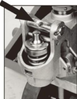
4. Hvis hullet er rettet forkert, vil pumpehåndtagets kæde, der skal trækkes gennem hullet, blive S-formet og vanskelig at håndtere.
