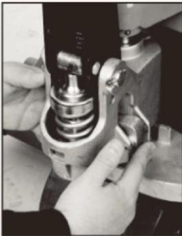
11.Pump med håndtaget nogle gange for at hæve gaflerne. Placer pumpehåndtaget i neutral position. Brug en 14 mm skruenøgle og en kærvskrueetrækker til at justere, så gaflerne ikke hæver eller sænker sig i denne position.
