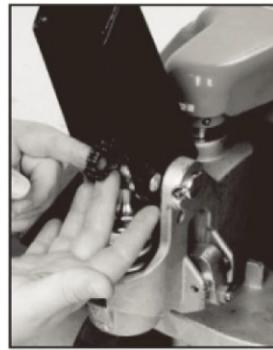
9. Når kæden er i korrekt stilling: kontroller, at den kan bevæge sig frit.
