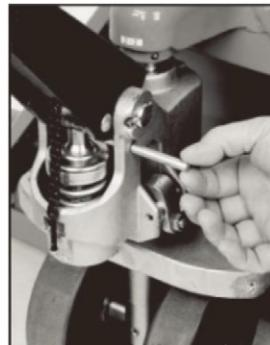
8. Syötä ketju ja asenna mutterit ketjun kierretakoon. **VINKKI!** Pumppukahvan asettaminen alimpaan asentoon helpottaa toimenpidettä.
