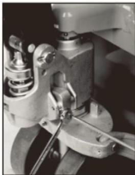
12.Pump håndtaget med fuld vandring for at fyldе systemet og fjerne luft fra det. Pumpehåndtaget skal kontrolleres i laveste position, hvor kæden er udsat for størst tryk. Når løftevognen er kontrolleret og i funktionsdygtig stand, monteres den anden sikkerhedssplit på den anden side med en hammer.
