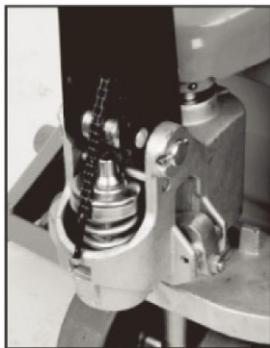
7. Træk håndtaget ned for at aflaste trykket på transportstiften, der sidder i hullet under bolten. Fjern forsigtigt transportstiften.
