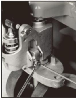
12. Pumpa handtaget med hela tag för att prima och eliminera luft från systemet. Pumphandtaget ska kontrolleras vid den längsta positionen då kedjan är utsatt för mest tryck. När handtrucken är kontrollerad och i funktionsgott skick, montera den andra säkerhetssprinten på andra sidan med en hammare.
