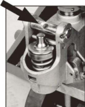
4. Hvis hullet vender feil vei, vil pumpehåndtakets kjede, som skal trekkes gjennom hullet, bli S-formet og vanskelig å betjene.
