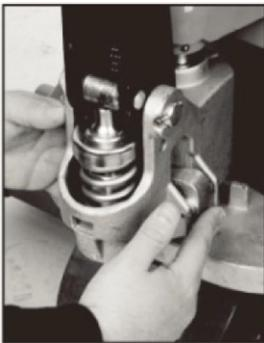
11. Pump håndtaket noen ganger for å løfte gaflene. Still pumpehåndtaket i nøytral posisjon. Bruk en 14 mm skiftenøkkel og en flat skrutrekker til å justere slik at gaflene ikke heves eller senkes i denne posisjonen.
