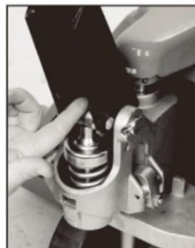
10.Tryk på aflastningsventilen for at løfte U-bøjlen i pumpehuset og føre enden af kæden igennem.
