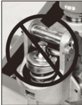
5. Før bolten ud til kanten for at føre kæden på ydersiden (se venstre pil). Sæt hullerne på linje, og tryk bolten ind igen (se højre pil).
