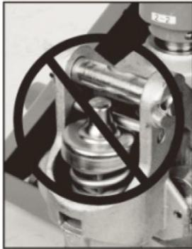
5. Før ut bolten til kanten for å mate kjedet på utsiden (se venstre pil). Juster hullene på linje, og press inn bolten igjen (se pilen til høyre).
