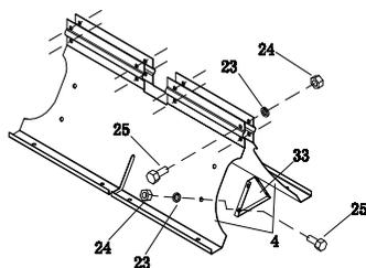
**C.** Asenna vetoaisan kiinnike (3) pohjalevyihin kahdella ruuvilla (22), aluslevyillä (23) ja muttereilla (24).
