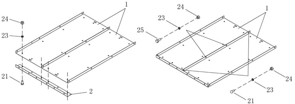
**A.** Plasser de to bunnplatene (1) side ved side, og monter den fremre festeskinne (2) ved hjelp av fire skruer (21), skiver (23) og muttere (24) på platene.
