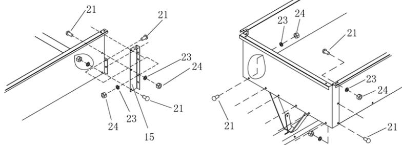
**M.** Säkra sidoplåtarna med fästskenor (15). Använd fem skruvar (21), brickor (23) och muttrar (24).
