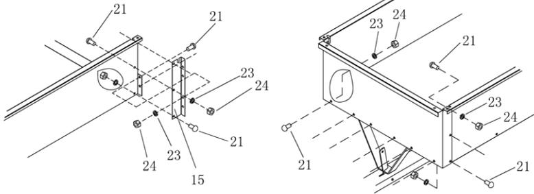
**M.** Kiinnitä sivulevyt kiinnityskiskoilla (15). Käytä viittä ruuvia (21), aluslevyjä (23) ja muttereita (24).
