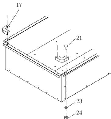
**O.** Montera hörnskydden (17) i de främre hörnen med hjälp av två skruvar (21), brickor (23) och muttrar (24).
