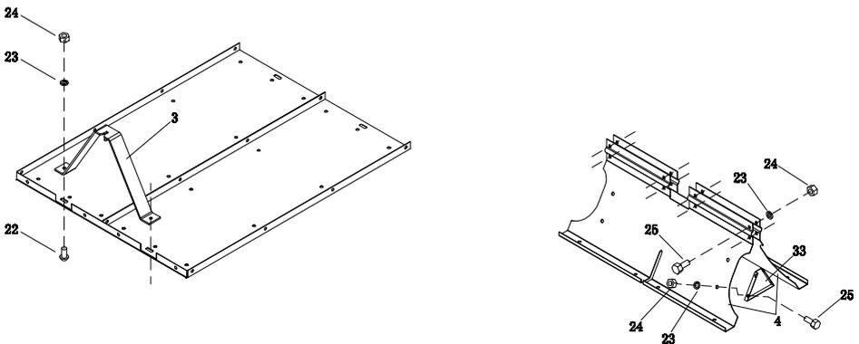
**C.** Monter trekkstangfestet (3) på bunnplatene med to skruer (22), skiver (23) og muttere (24).
