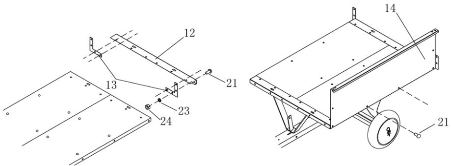
**I.** Vend påhængsvognen om og monter vinkelskinnen (13) på den bageste monteringsskinne (12) med fire skruer (21), skiver (23) og møtrikker (24)
