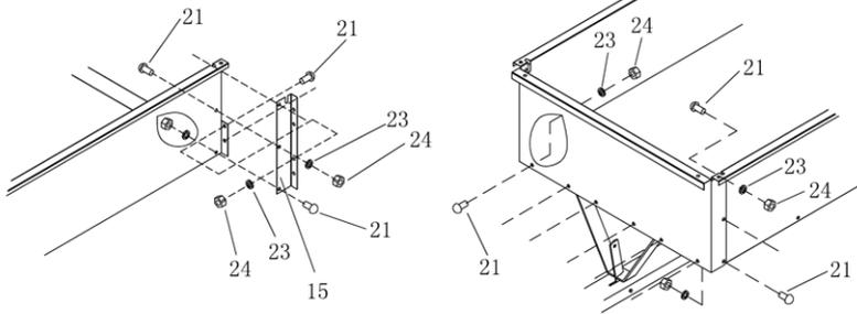
**M.** Sikre sideplatene med festeskiner (15). Bruk fem skruer (21), skiver (23) og muttere (24).
