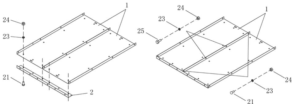
**A.** Aseta kaksi pohjalevyä (1) vierekkäin. Asenna etuosan kiinnityskisko (2) neljällä ruuvilla (21), aluslevyillä (23) ja muttereilla (24) levyjen päälle.
