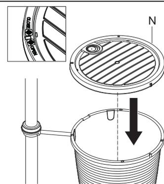
Såga ett snitt i stuprännan och montera avrinningsmodul. Värm slangen och tryck fast. Placera locket./Såg et snitt i nedløpsrøret, og monter avrenningsmodul. Varm opp slangen, og trykk den fast. Plasser lokket.
