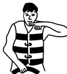
STANS MOTOREN – PEKEFINGER PEKER PÅ HAKEN
