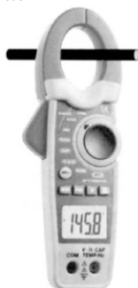
Korrekt utført måling 1 stk. leder
