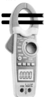
Feil utført måling 2 stk. ledere
