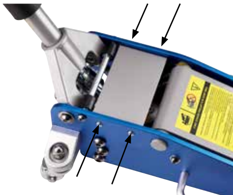
2. Lossa skruvar för att nå påfyllnadsplugg.
