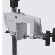
Aseta moottorin kiinnike veneen peräpeiliin. Lukitse kiinnike peräpeiliin siipiruuvien (1) avulla. Säädä moottorin kulmaa tarttumalla moottorin suojukseen yhdellä kädellä ja painamalla punaista lukkosokkaa (2) toisella kädellä. Lukkosokka on jousitettu, joten se palaa valittuun asentoon. Varmista, että moottori kiinnittyy valittuun asentoon kunnolla.
