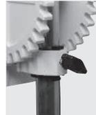
Perämoottori voidaan lukita tiettyyn ajosuuntaan kiristämällä moottorin kiinnikkeen takaosan siipiruuvi (4). Älä kiristä siipiruuvia liian tiukalle.
