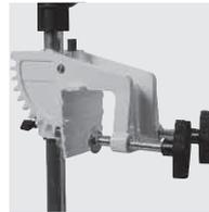
Plasser motorens opphengsbøyle på båten akterspeil. Lås opphengsbøylen fast til akterspeilet ved hjelp av de to vingeskruene (1). Juster motorens vinkel ved å holde i motorhodet med den ene hånden og å trykke inn den røde låsesplinten (2) med den andre hånden. Låsesplinten er fjærbelastet og går tilbake i valgt posisjon. Forsikre deg om at motoren er ordentlig låst i den valgte posisjonen.
