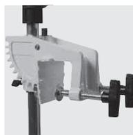
Placer motorens ophængsbøjle på bådens agterspejl. Lås ophængsbøjlen fast på agterspejlet med de to vingeskruer (1). Juster motorens vinkel ved at holde i motorhovedet med den ene hånd og trykke den røde låsepind (2) ind med den anden hånd. Låsepinden er fjederbelastet og går tilbage til den valgte position. Kontroller, at motoren er ordentligt låst i den valgte position.
