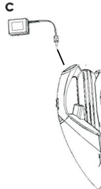
Hæng støvsugeren på konsollen med håndtaget opad (en krog på bagsiden af apparatet holder den fast på konsollen, se billede C).
