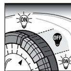
Innstillingsskiven har 96 tidssegmenter som hvert representerer 15 minutter. Trykk ned de segmentene som representerer de klokkeslettene på døgnet som apparatet skal være slått på, f.eks. 08.00 – 12.00. Da starter apparatet mellom disse klokkeslettene hvert døgn.
