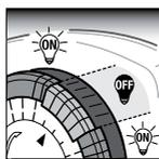
På inställningsskivan finns 96 tidsegment som representerar 15 minuter var. Tryck ner de segment som representerar de klockslag på dygnet som apparaten ska vara påslagen, t.ex. 08:00 – 12:00. Då startar apparaten mellan dessa klockslag varje dygn.
