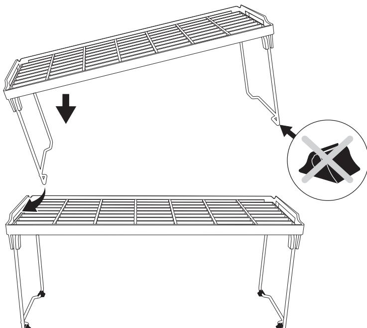
Om man vill kan fler hyllplan läggas till på samma sätt. Total maximal belastning är 8 kg.
