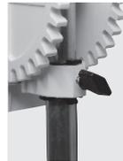
Motoren kan låses i en valgt kurs ved at man strammer vingeskruen (4) i den bakre delen på motorens opphengsbøyle. Stram ikke vingeskruen for hardt.
