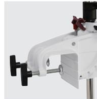
Placer motorens ophængsbøjle på bådens agterspejl. Lås ophængsbøjlen fast på agterspejlet med de to vingskruer (1). Juster motorens vinkel ved at holde i motorhovedet med den ene hånd og trykke den røde låsepind (2) ind med den anden hånd. Låsepinden er fjederbelastet og går tilbage til den valgte position. Kontroller, at motoren er ordentligt låst i den valgte position.
