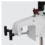
Aseta moottorin kiinnike veneen peräpeiliin. Lukitse kiinnike peräpeiliin siipiruuvien (1) avulla. Sääda moottorin kulmaa tarttumalla moottorin suojukseen yhdellä kädellä ja painamalla punaista lukkosokkaa (2) toisella kädellä. Lukkosokka on jousitettu, joten se palaa valittuun asentoon. Varmista, että moottori kiinnittyy valittuun asentoon kunnolla.
