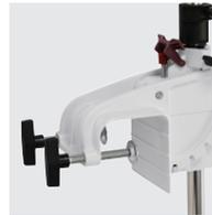
Plasser motorens opphengsbøyle på båten akterspeil. Lås opphengsbøyle fast til akterspeilet ved hjelp av de to vingeskruene (1). Juster motorens vinkel ved å holde i motorhodet med den ene hånden og å trykke inn den røde låsesplinten (2) med den andre hånden. Låsesplinten er fjærbelastet og går tilbake i valgt posisjon. Forsikre deg om at motoren er ordentlig låst i den valgte posisjonen.
