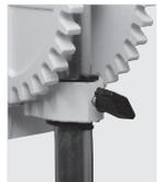
Perämoottori voidaan lukita tiettyyn ajosuuntaan kiristämällä moottorin kiinnikkeen taakosan siipiruuvi (4). Älä kiristä siipiruuvia liian tiukalle.
