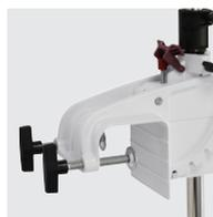
Placera motorns upphängningsbygel på båtens akterspegel. Lås fast upphängningsbygeln vid akterspegeln med hjälp av de båda vingskruvarna (1). Justera motorns vinkel genom att hålla i motorhuvudet med den ena handen, samt trycka in den röda låsspringen (2) med den andra handen. Låsspringen är fjäderbelastad och återgår i vald position. Säkerställ att motorn är ordentligt låst i det valda läget.
